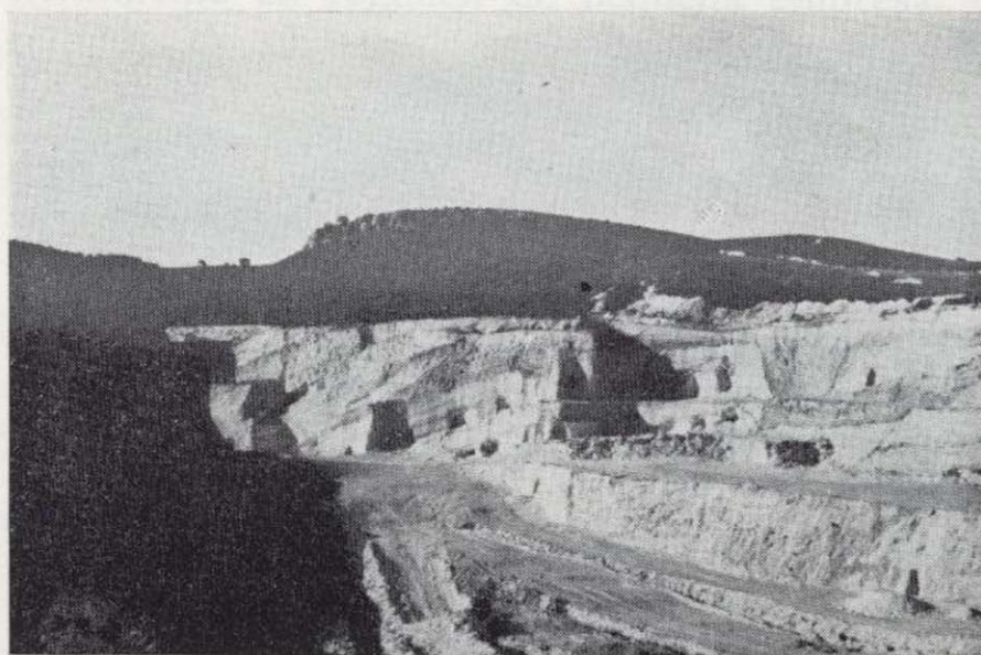
Figura 4.—Cantera Portela. Elche de la Sierra. Vista del sector explotado en régimen de cámaras y pilares.
