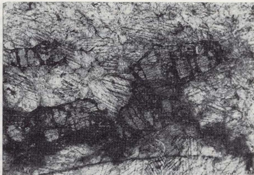
Figura 8.—Aspecto microscópico de una carbonatita egrínica (núm. 32159). Obsérvense los cristales de egrina con borde de oxidación negruzco. Luz natural \times 10 .
